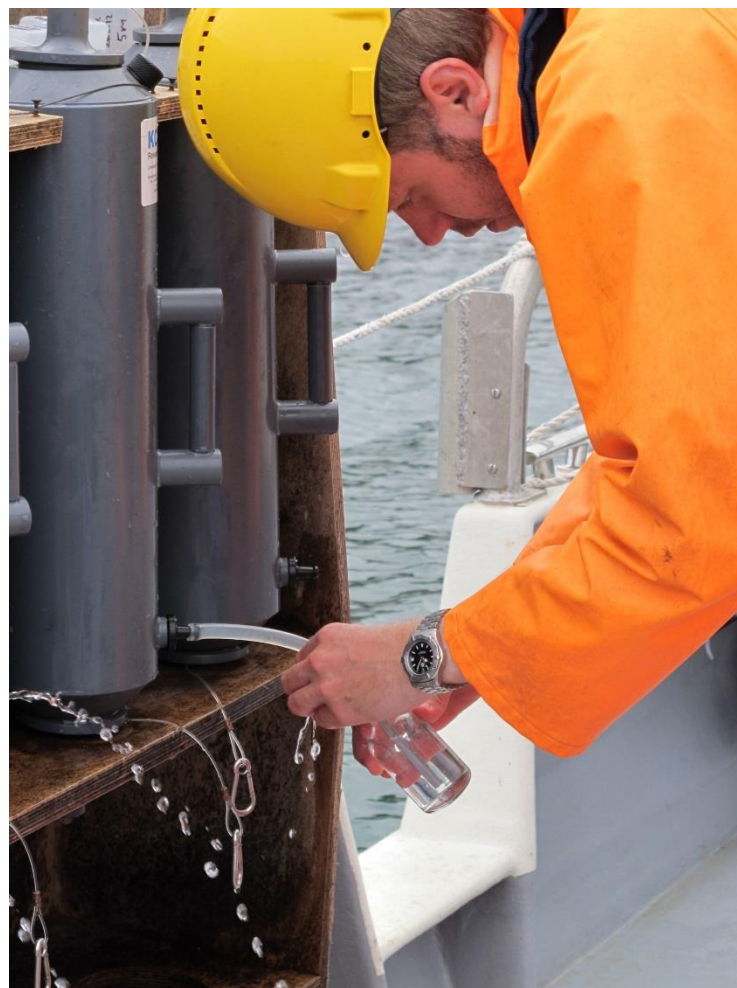
Figur 3.1.11 Prøvetaking av bunnvann til Winklers analyse av oksygenkonsentrasjon.
