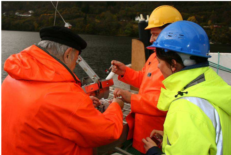
Foto: Uttak av prøve til kornfordelingsanalyser.
